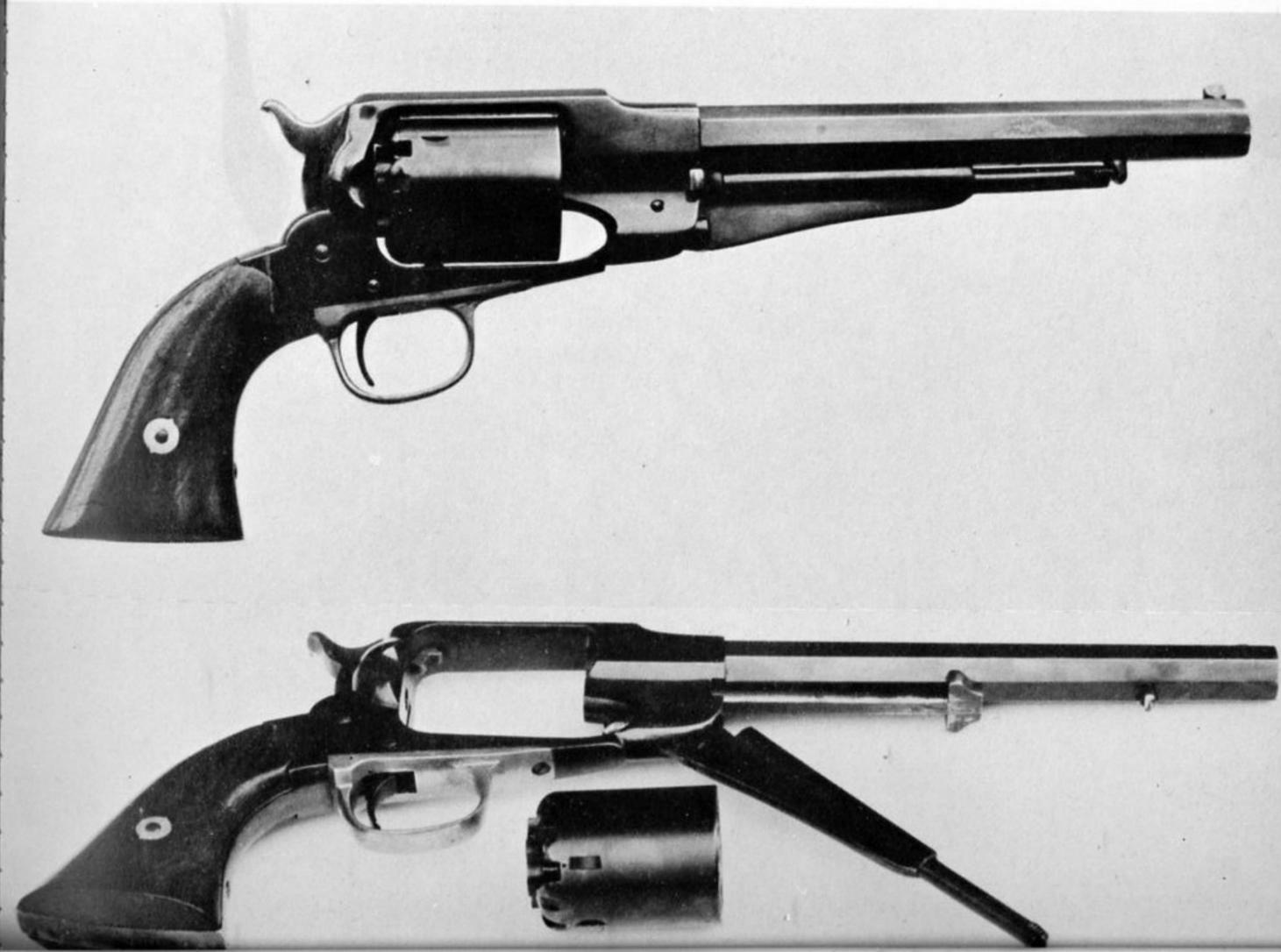
sich so fein einstellen läßt, wie bei einem modernen Scheibrevolver. Remington-Replikas mit Matchvisier sind im Handel. Etwas einfacher als bei den Colts ist infolge des geschlossenen Rahmens die Trommeldemontage bei Remington. Es gibt keinen Verriegelungskeil, der mit dem Holzhammer herausgeschlagen werden muß, die Remington-Trommel sitzt auf einer Steckachse, die sich an ihrem Kopf-Griff herausziehen läßt, wenn der Hebel der Ladepresse nach unten geschwenkt ist. Damit wird die Trommel frei.
