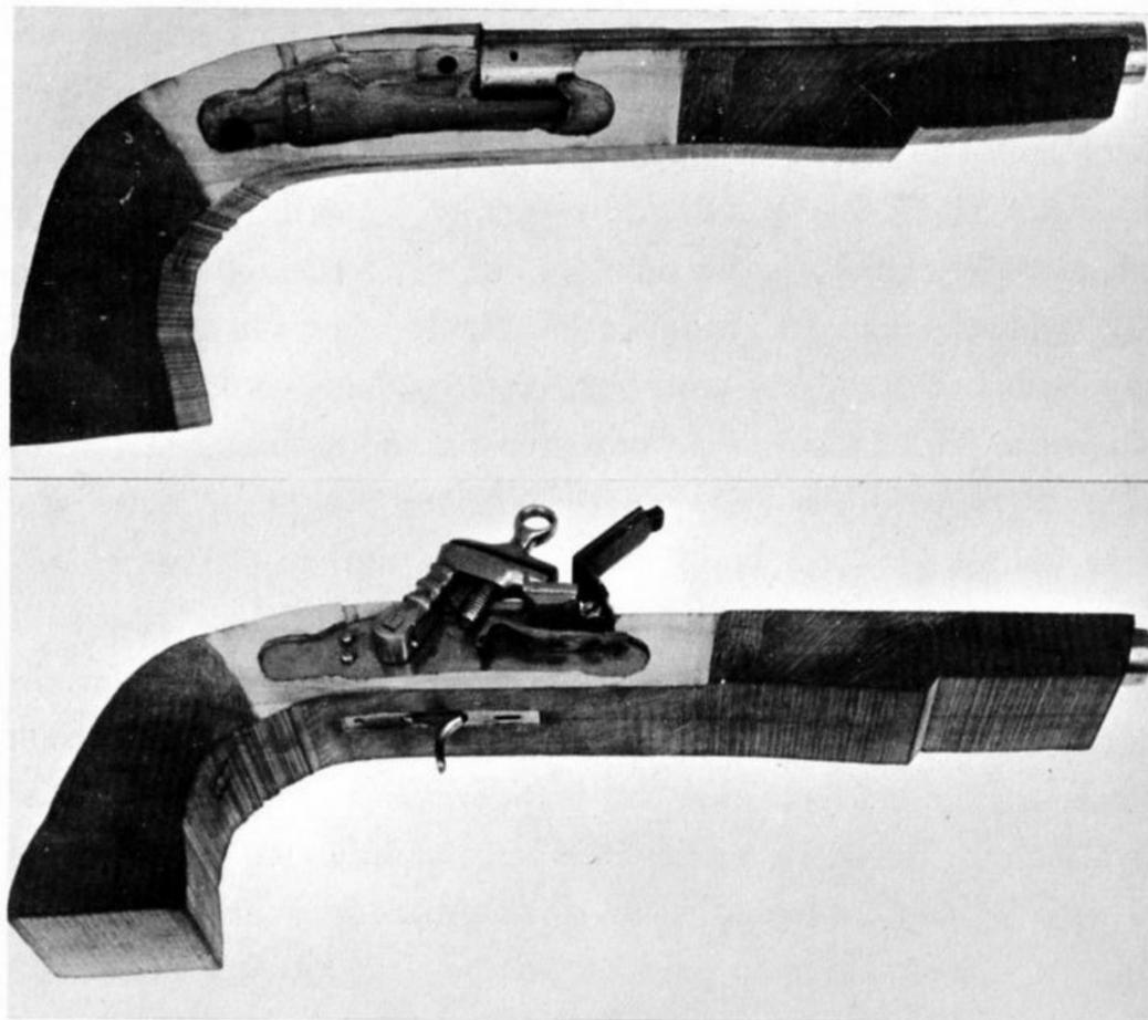
Selbstbau einer Steinschloßpistole. Der Lauf ist im Schaft eingelassen und die Aussparung für das Schloß grob ausgestochen (oben). Anschließend werden Schloß und Abzugseinrichtung eingepaßt (unten).
