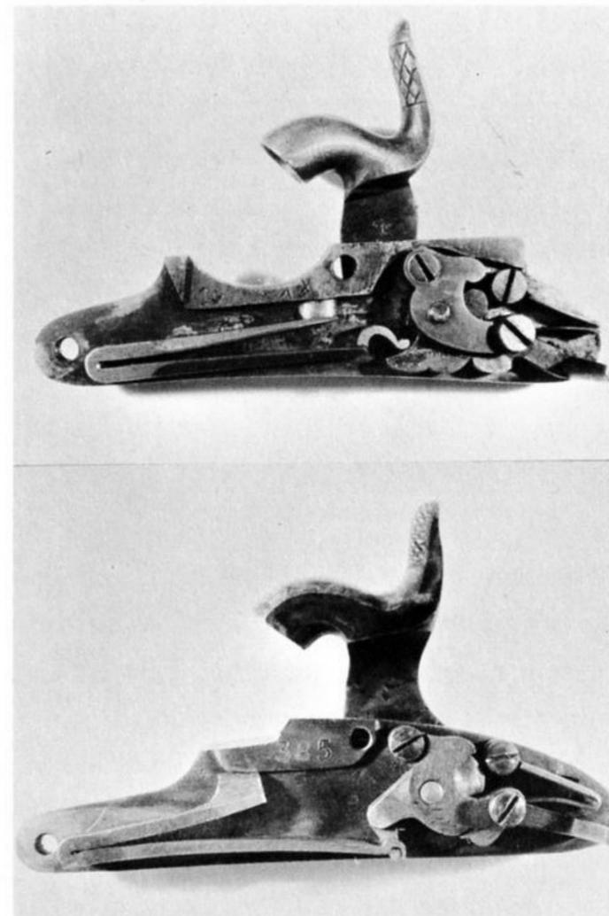
Perkussionsschlösser (Rückseiten). Oben: normale Bauweise mit unmittelbar aufliegender Hauptfeder. Unten: Ketenschloß. Die Hauptfeder ist beweglich an der Nuß aufgehängt.
