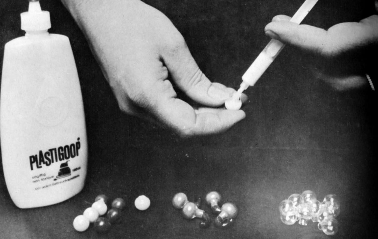
Herstellung von „Plastigoop“-Geschossen. Das Kunststoffmaterial wird mit einer kleinen Injektionsspritze (ohne Nadel) in die Glasformen gefüllt. Die gefüllten Formen werden „gebacken“ und anschließend zerschlagen.
