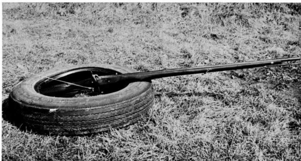
Anordnung für den »privaten Beschuß«, zur Haltbarkeitsprüfung alter Waffen. Die Waffe wird überladen, in einem Autoreifen befestigt und mit der Schnur aus sicherer Entfernung abgezogen.
