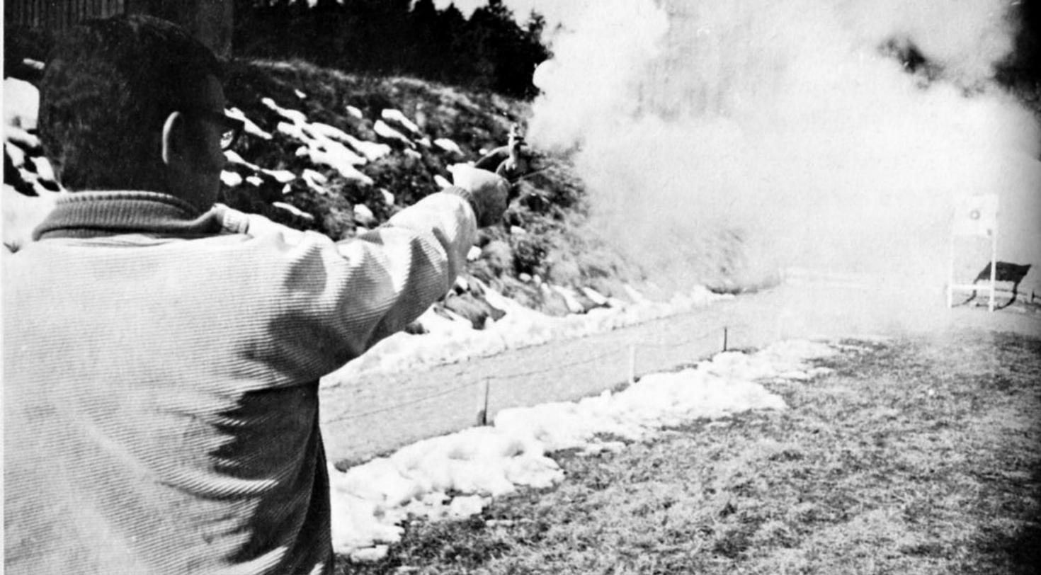
Abfeuern einer Steinschloßpistole. Typisch ist die separate Dampfwolke, die seitlich von der Pfanne aufsteigt. Der Schuß zündet mit mehreren Zehntelsekunden Verspätung.
