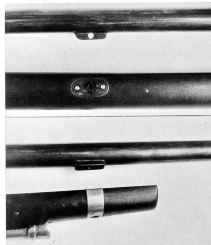
Laufbefestigung beim Perkussionsgewehr. Oben: Laufmitte, unten: Befestigung an der Mündung.
