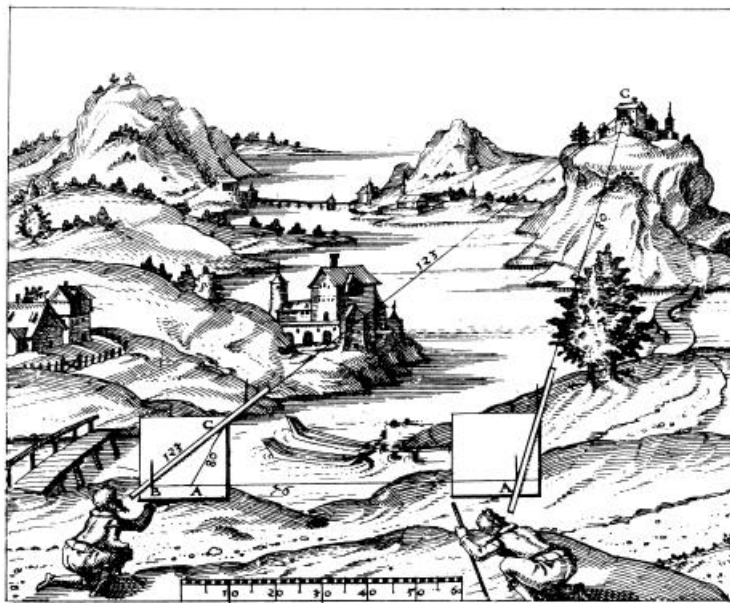
Abb. 24: Messung mit Messtisch von 2 Punkten aus. 60
