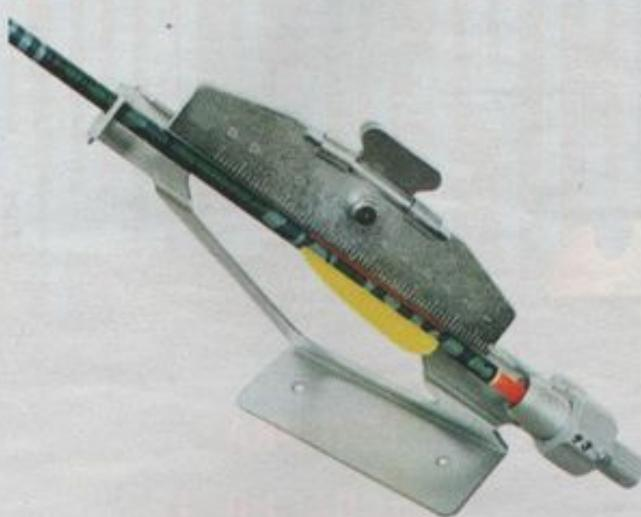
ками, намазывают клеем и прижимают к трубке – после высыхания трубку поворачивают на 90 или 120 градусов
